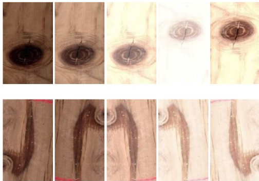
图2 扩展后的部分缺陷图片 Fig.2 Defect image data set extension
